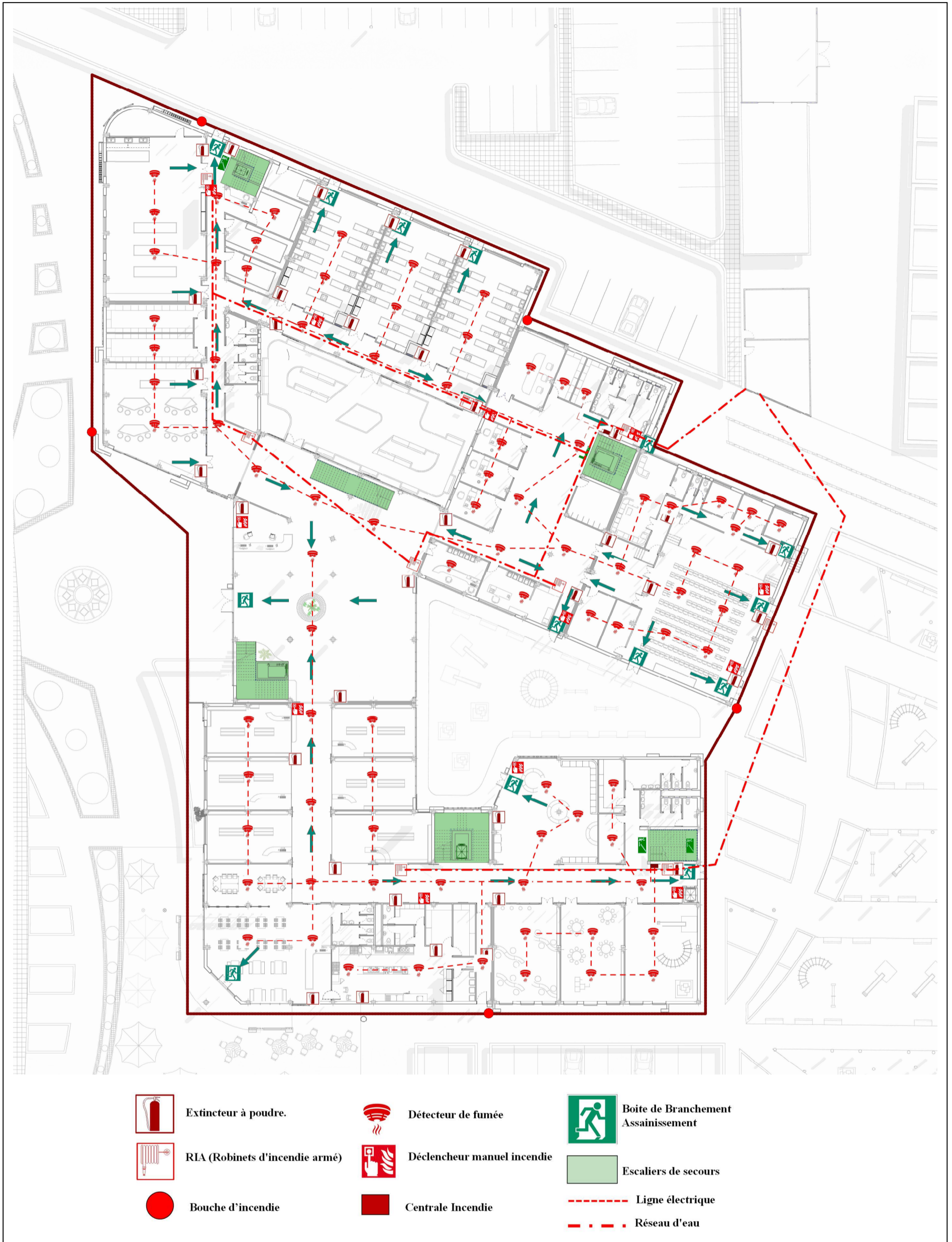
Figure 212: PLAN ANTI INCENDIE RDC Source : Auteur
