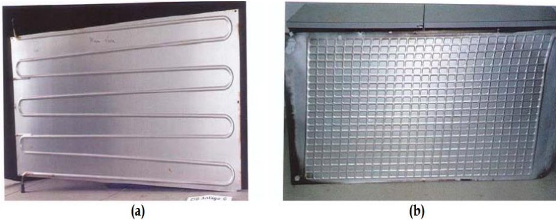
Figure II.18 : Exemples des absorbeurs [15]
