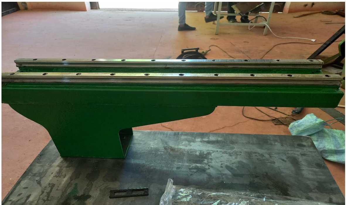
Figure V- 3 : Montage des rails de guidage.
