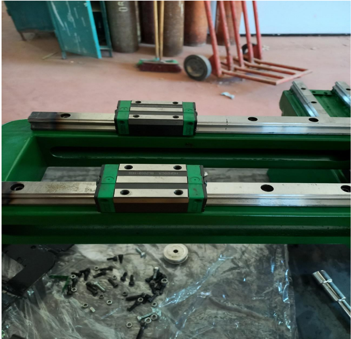
Figure V- 6 : Montage des rails et roulements.
