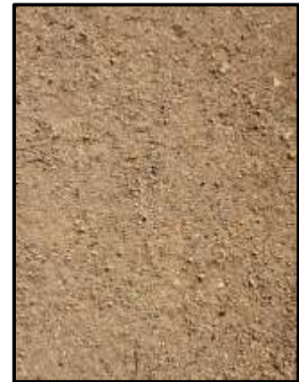
Figure 81 : : Revêtement de cheminement équestre (sable) (source : https://pin.it/6FwUcKOAu )
