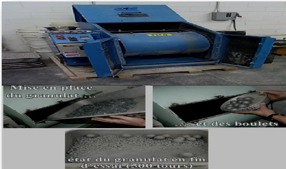
Figure 3. 7 : Essai Los Angeles.
