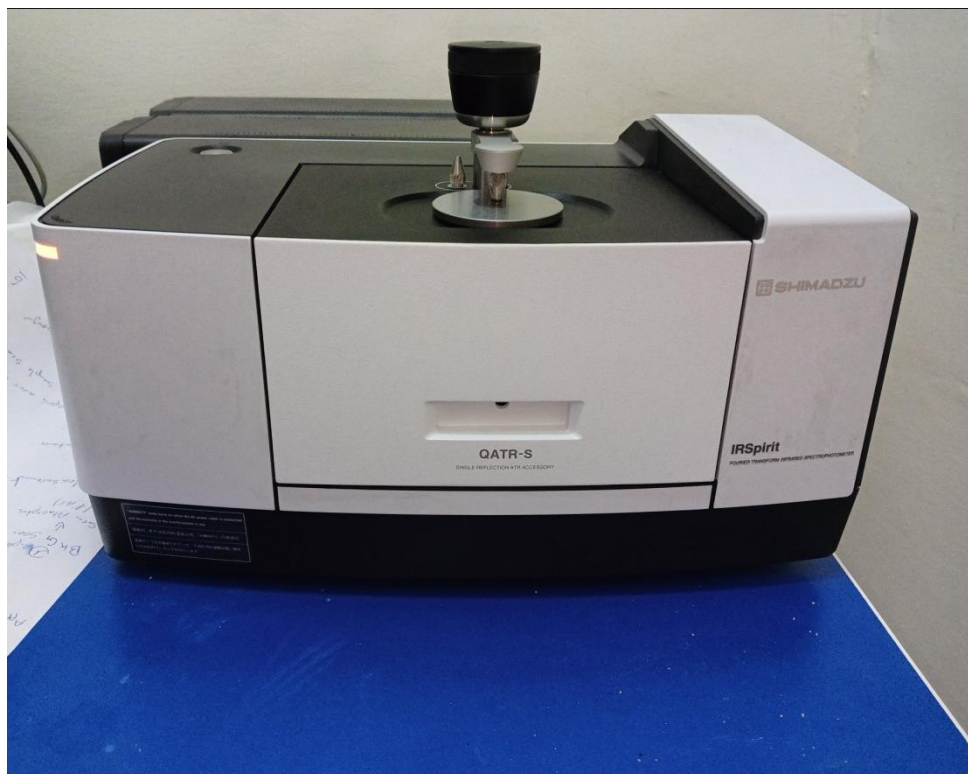
Figure 16 : Spectrophotomètre infrarouge à transformée de fourier (FTIR) IRSpirit de Shimadzu équipé de l'accessoire ATR QATR-S.
