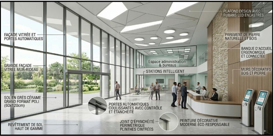
Figure 116 : Détails des revêtements et des équipements techniques de l'accueil
