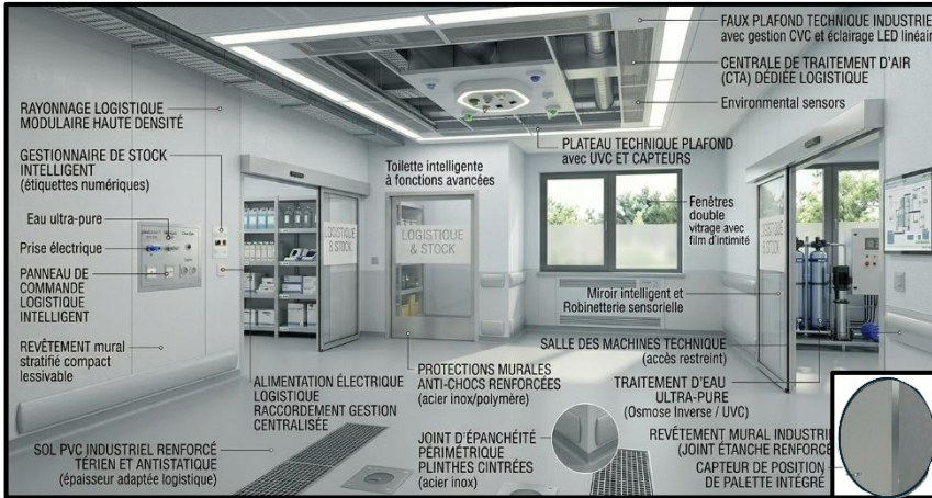
Figure 115 : Détails des revêtements et des équipements techniques des locaux technique et logistique
