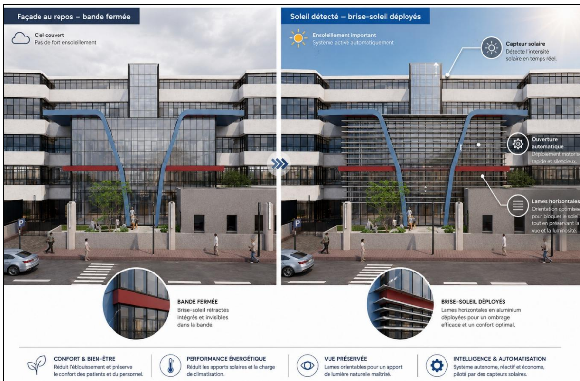
Figure 110 : brise soleil horizontal automatique intelligente (façade SUD )
