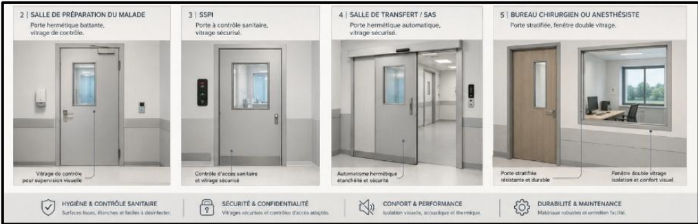
Figure 120 Menuiserie Bloc opératoire
