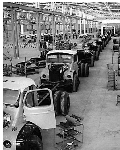
Fig 10 : Finition des véhicules avant la livraison sur la chaîne, usine Berliet de Rouïba I -Algérie-, Fondation de l'automobile Marius Berliet - Lyon (1958) 77
