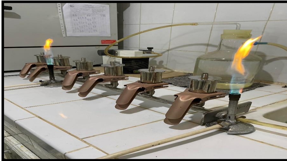
Figure 34 : Appareil de la filtration sur membrane.
