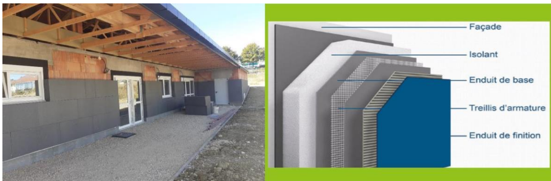
Figure II.2 Isolation Thermique par l'Extérieur (ITE)
