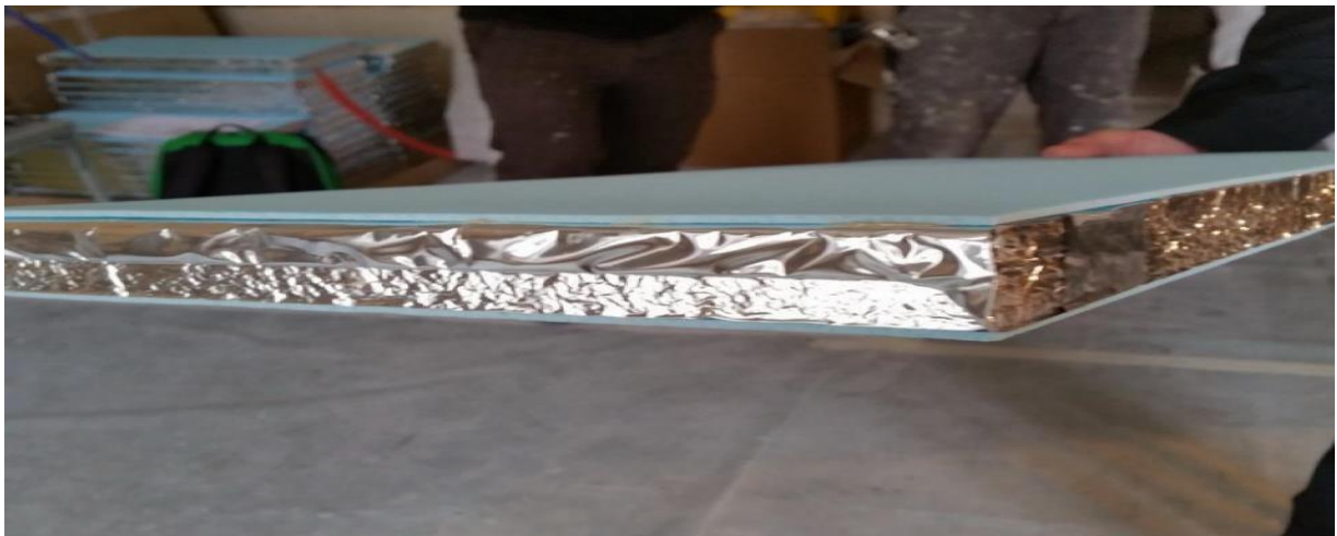
Figure II.11 Panneaux Isolants sous Vide (PIV)
