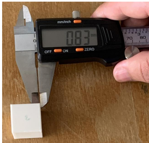
Figure III-9 Mesure avec pied à coulisse
