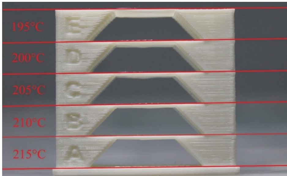
Figure II-27 Températures des sections de la tour imprimée
