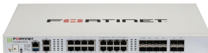
Figure 2.3 : Firewall FortiGate de la série 200G
