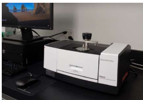
Figure 21: Appareil FTIR-ATR utilisé pour l'identification des matériaux plastiques
