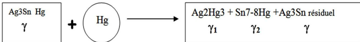
Figure 6 : Réaction de prise d'un amalgame conventionnel
