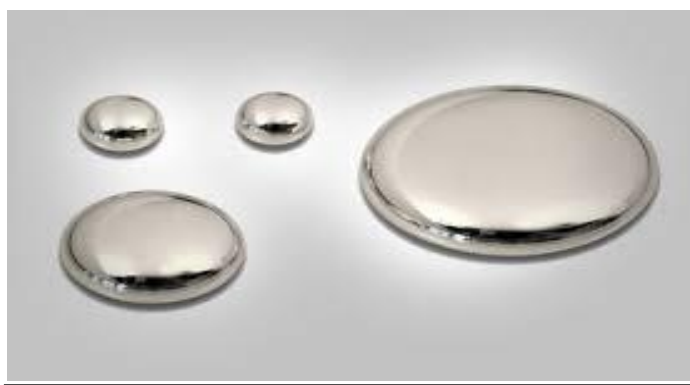
Figure 1: Mercure élémentaire pur à l'état liquide à température ambiante
