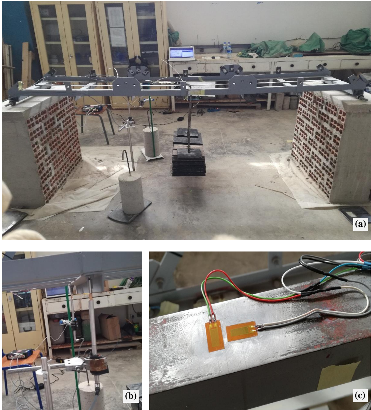
Figure V- 6 – Dispositif expérimental de mesure des déplacements et de contraintes sur le modèle prototype, (a) : Modèle soumis au chargement ; (b) : Capteur de déplacement ; (c) : Jauge de contraintes montées en \frac{1}{2} pont).
