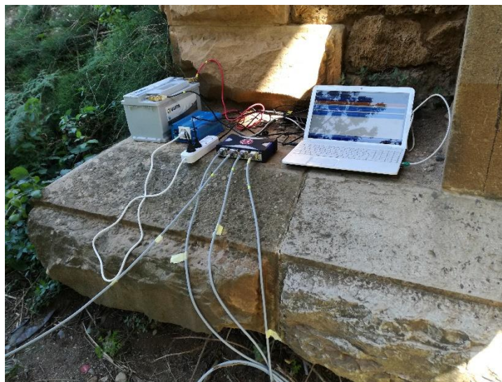
Photo 2 – Dispositif d'acquisition des données.
