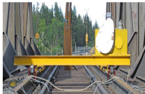
Figure II-14– Secoueur de charge sur le pont [91].
