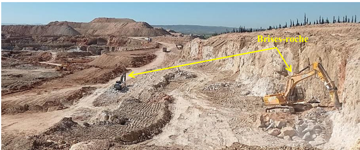
Figure 13 : Extraction mécanique à la carrière Knauf effectuée par des brises-roche
