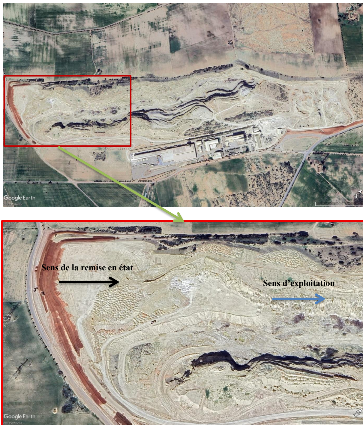
Figure 25 : Remise en état progressive en parallèle des travaux d'exploitations
