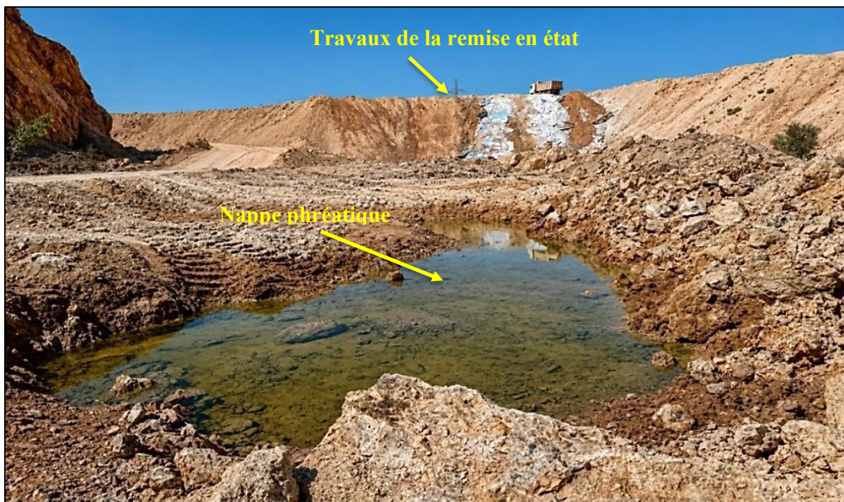
Figure 24 : Apparition de la nappe phréatique au niveau 84 mètres à la carrière de Fleurus
