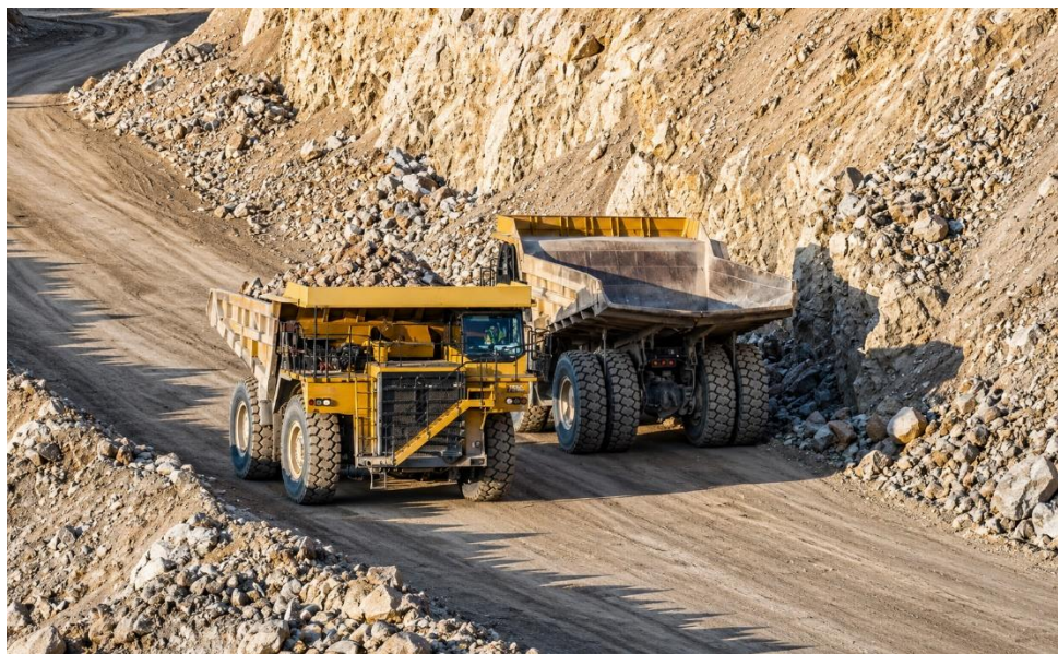
Figure 20 : transport du gypse vers l'unité de traitement
