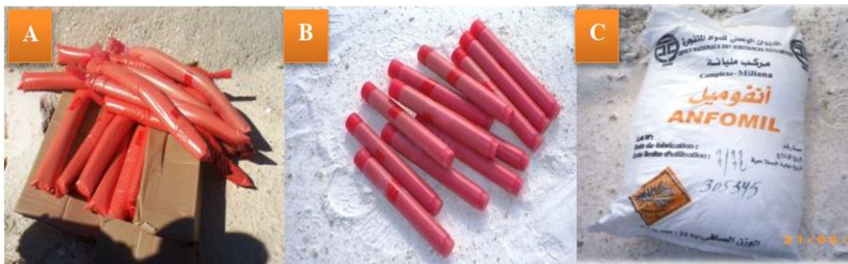
Figure 18 : Types d'explosifs utilisés dans les tirs de mine A : Marmanit, B : Les explosifs gélatineux ; Gélanite, C : explosif en vrac : Anfomil
