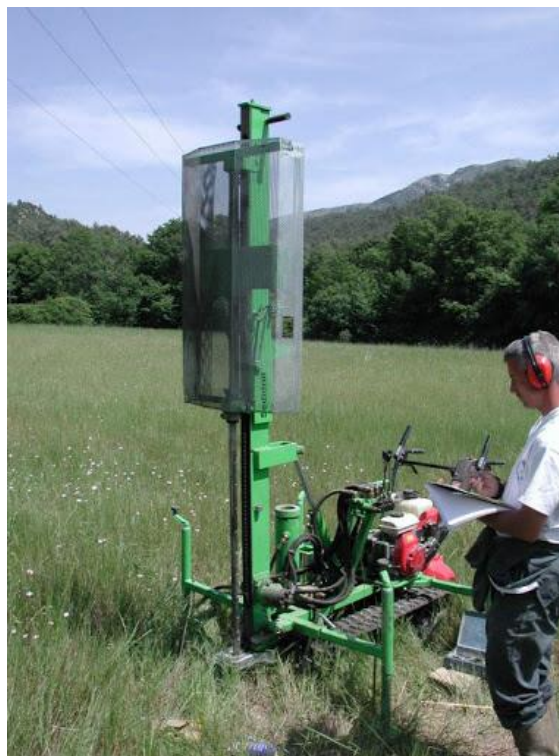
Figure 2.14 : Essai de pénétration dynamique.
