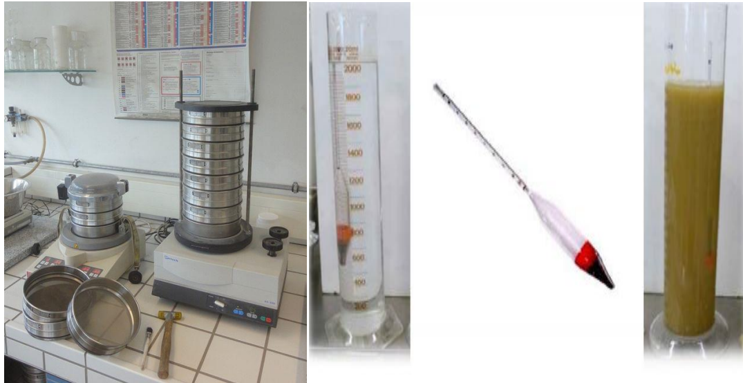
a. Essai de tamisage humide
