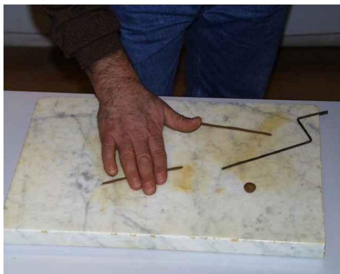
b. Essai de limite de plasticité par la méthode au rouleau
