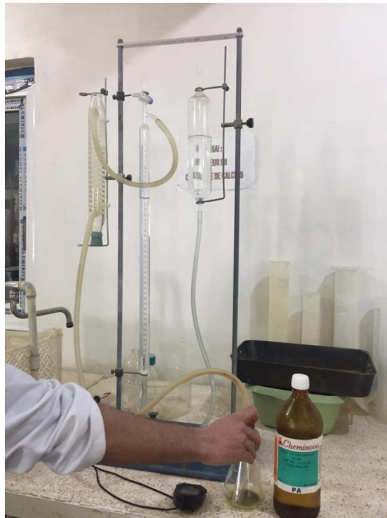
Figure 2.9 : Essai du calcimètre pour la teneur en carbonates.
