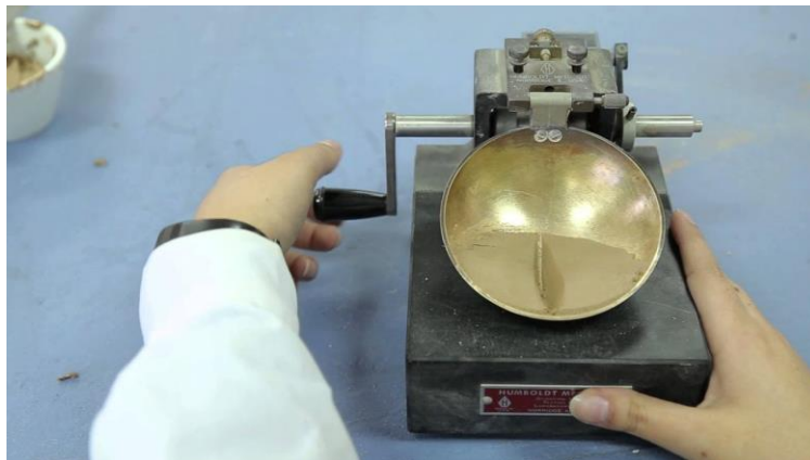
a. Essai de limite de liquidité par la méthode de Casagrande
