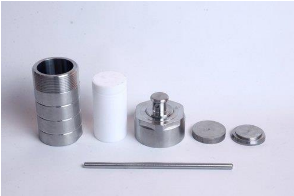
Figure(13) : Image représentant les composants de l'autoclave
