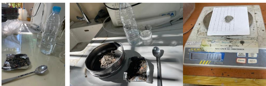
Photo 1 : Préparation d'un échantillon rocheux pour l'observation microscopique au laboratoire
