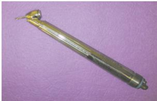
Figure 35: Instrument chirurgical avec tête à angle de 45 degrés et échappement d'air arrière.
