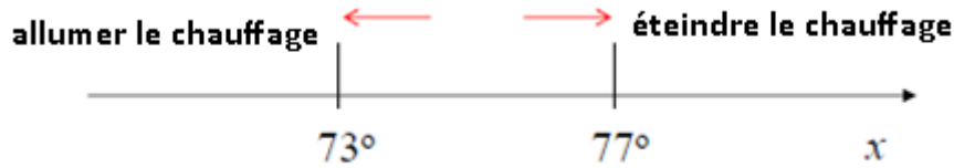
Figure 21: Le fonctionnement du thermostat.
