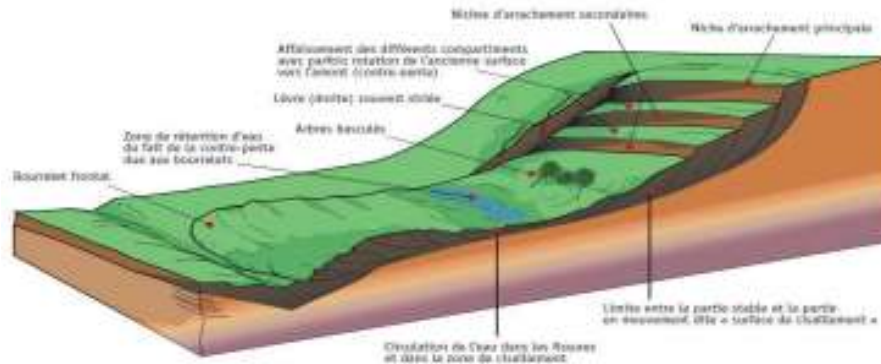
Figure 1.8: Schéma explicatif du phénomène: Glissement de terrain [06]
