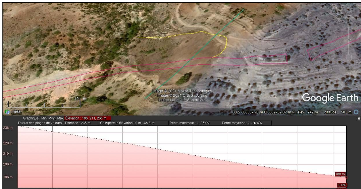
Figure 4.11: Profil en dénivelé présente la topographie du versant de la zone de glissement [20]
