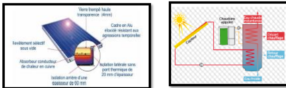
Figure256 : Fonctionnements des capteurs solaires
