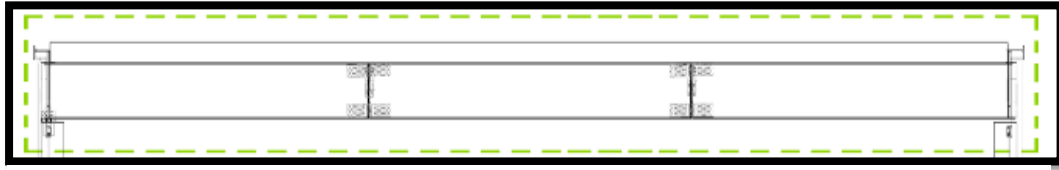
Figure 49 : Schéma d'une poutre –caisson
