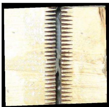
Figure 34 : Opération d'aboutage de lamelles
