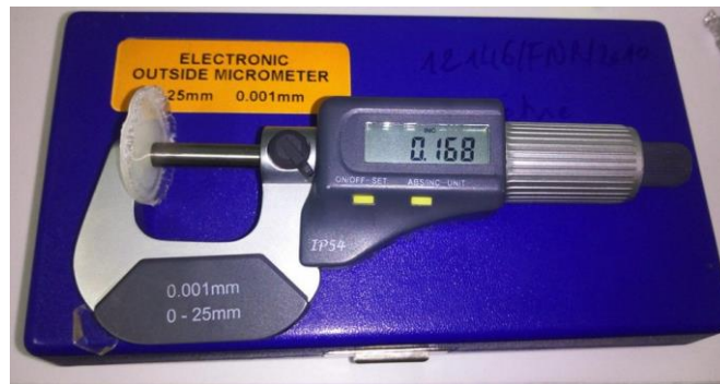
Figure II.6. Micromètre portable pour la mesure de l'épaisseur des films.
