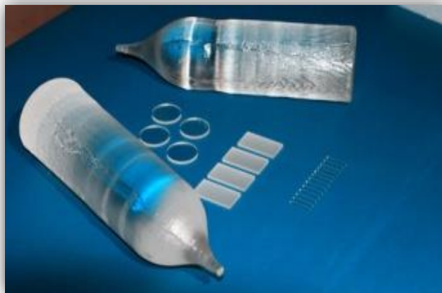
Figure I.4 : Exemple des scintillateurs inorganiques monocristallins.
