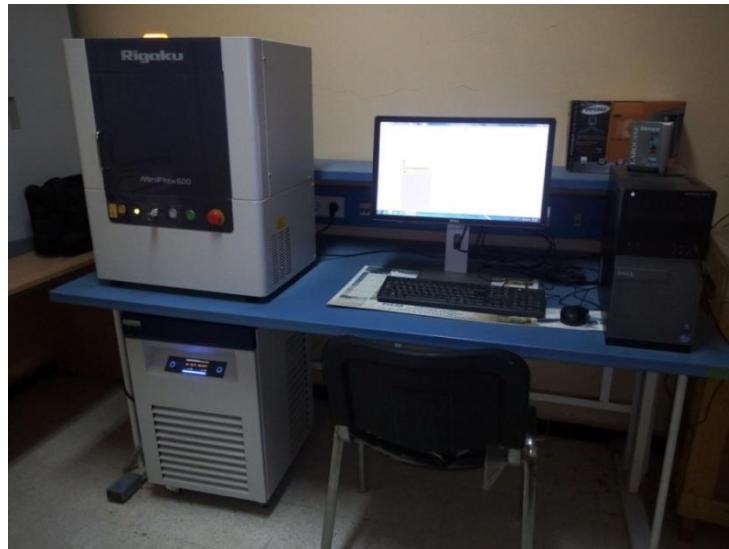
Figure II.14. Photo de l'appareil DRX utilisé type Miniflex600
