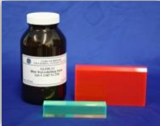
Figure I.3 : Exemple des scintillateurs organiques
