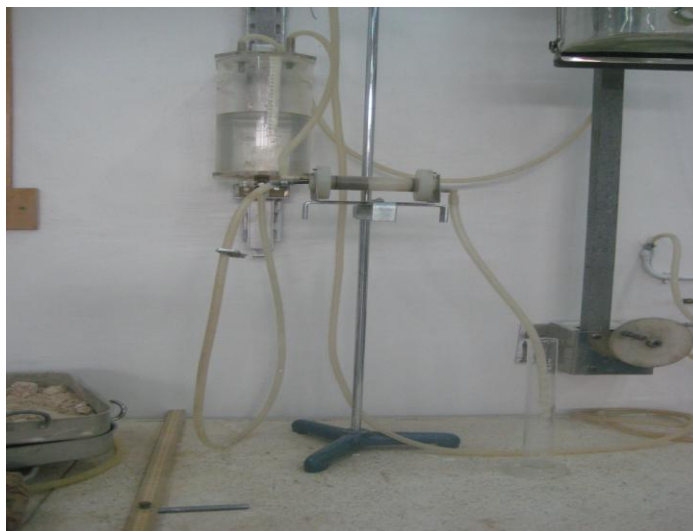
Photo 3.23 l'appareil de Pinhole test
