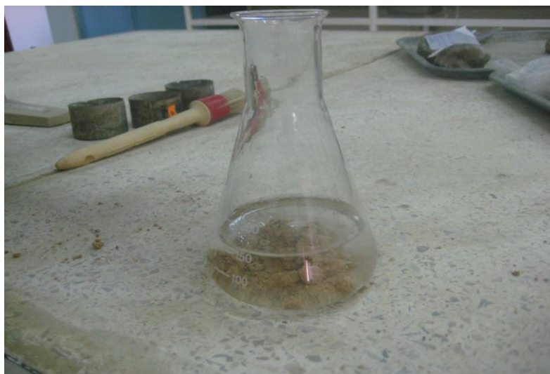
Photo 3.21 Essai de dispersion Crumb test
