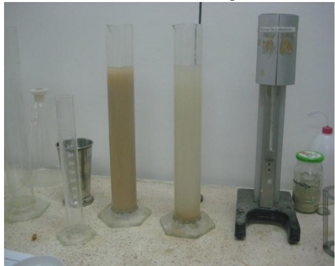
Photo 3.22 double hydrometer test (essais de sedimentometrie comparées)
