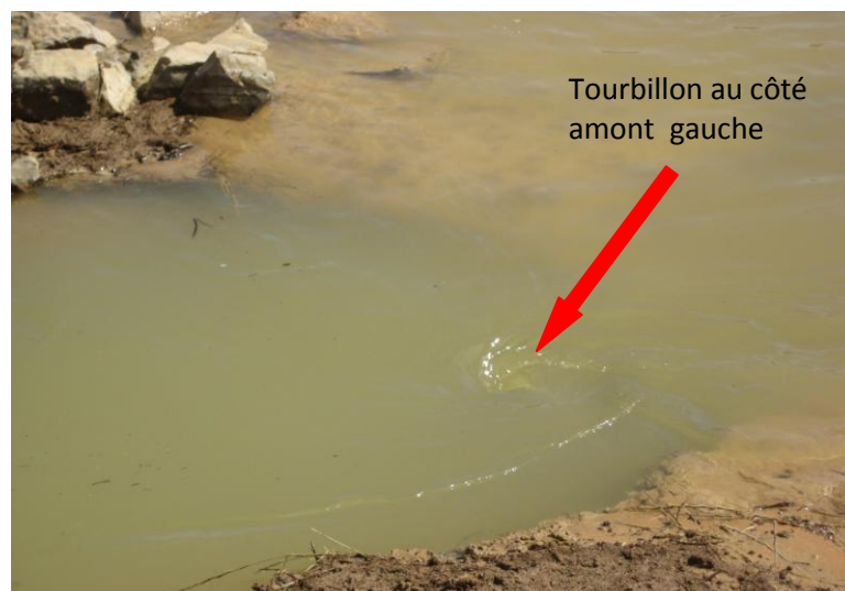
Photo 3.20 tourbillon au coté amont indique le transport de particules à l'aval
