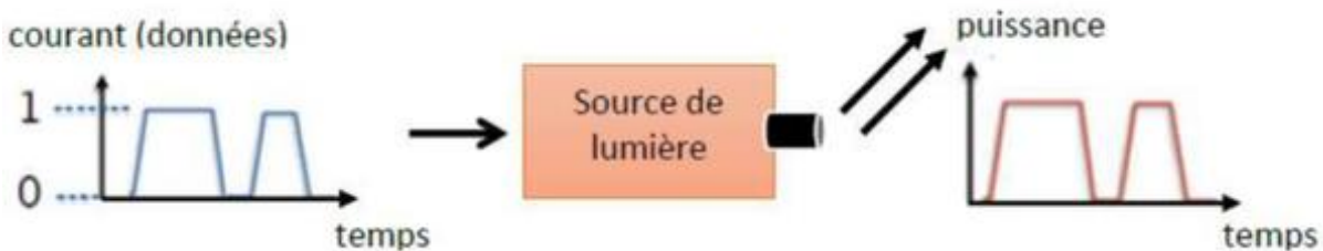
Figure II.4 : Principe de base d'une modulation directe [48].
