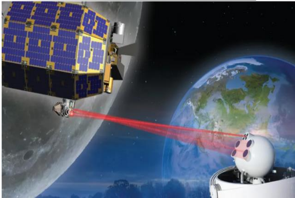
Figure II.11 : La démonstration de communications laser lunaires (LLCD) a mis en avant la technologie de communication par laser d'octobre 2013 à avril 2014 lors de la mission Lunar Atmosphere and Dust Environment Explorer (LADEE). NASA [68]
