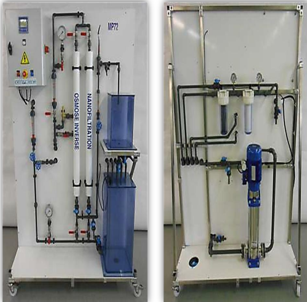
Figure 2: Vues face et arrière du pilote de nanofiltration (MP72).
