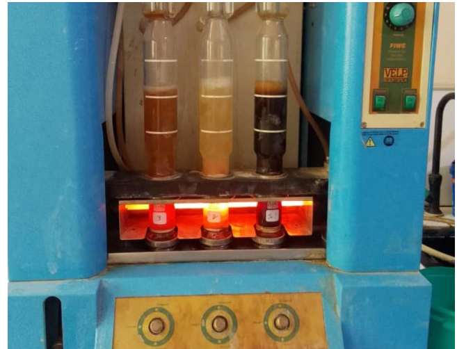
Figure 23 : le kaki et la patate douce dans l'extracteur des fibres (fibres-test) (Original)
