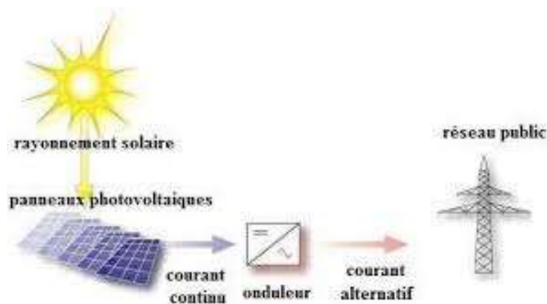
Figure 2. 3:Schéma de conversion de l'énergie solaire en électricité
