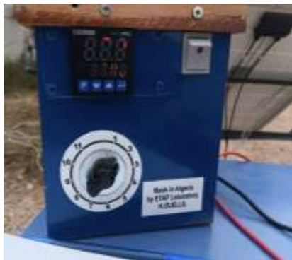
Figure 4. 10: Module de mesure de température numérique avec affichage intégré solarimètre
