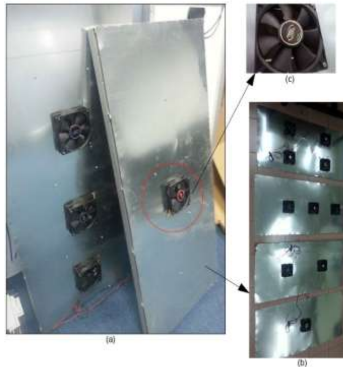
Figure 3. 3: Développement d'un mécanisme de refroidissement par ventilateur à courant continu.
