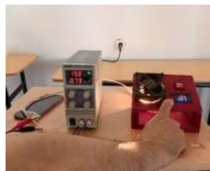
Figure 4. 10: Contrôle de précision entre l'alimentation de laboratoire et le système de mesure
