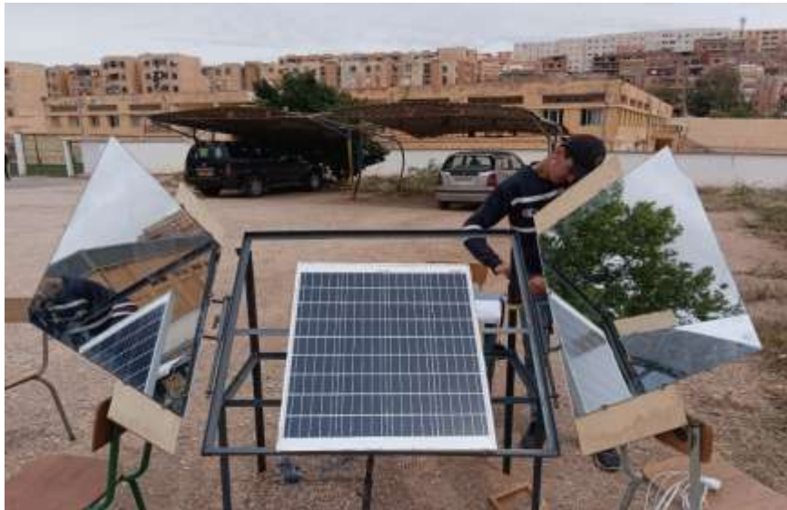
Figure 4. 2 : Représentation du panneau solaire sur le support mobile et les réflecteurs
