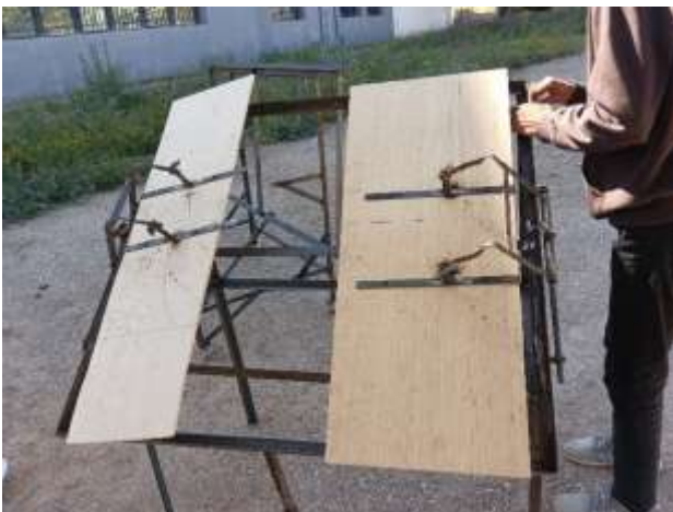
Figure 4. 12: Support ajustable pour panneau solaire et miroirs latéraux
