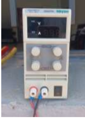
Figure 4. 7: Appareil servant à l'étalonnage du courant
