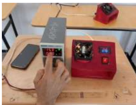
Figure 4. 10: Contrôle de précision entre l'alimentation de laboratoire et le système de mesure
