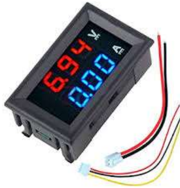
Figure 4. 6: Afficheur Voltmètre/Ampèremètre 10A-100V DC
