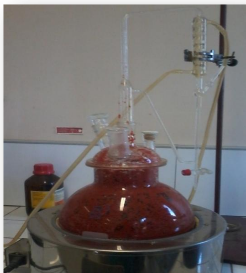
Figure 7 : Hydrodistillation de la matière sèche au moyen d'un dispositif d'extraction de type Clevenger .
