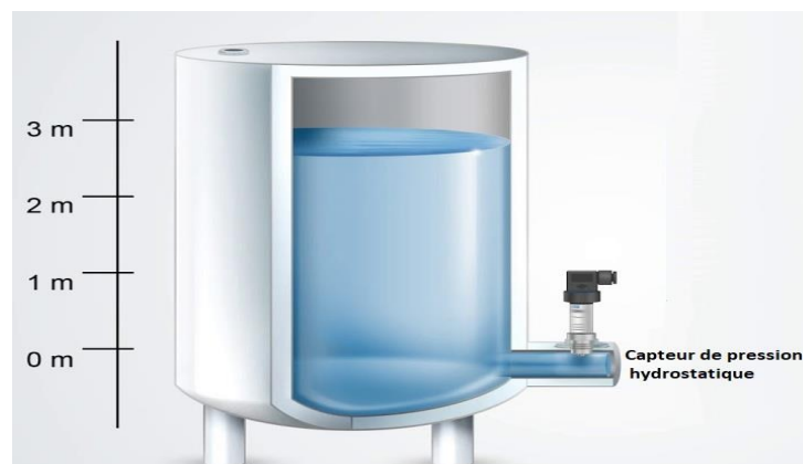
Fig 1 - 10 : Schéma explicatif d'un capteur de niveau hydrostatique [6]
