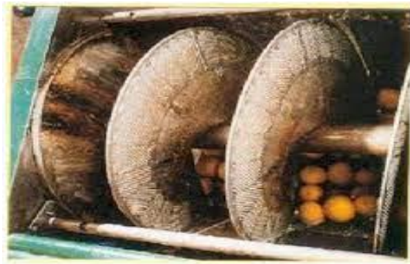
Figure 03 : Pression à froid des agrumes
