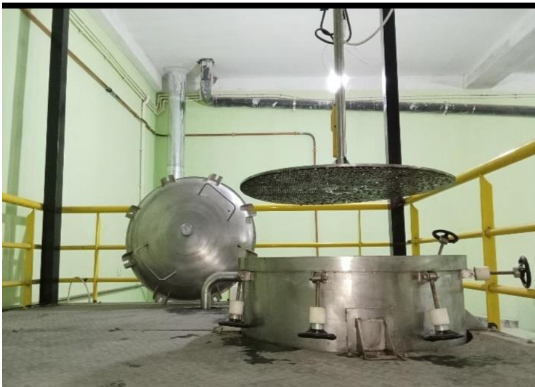
Figure 05: L'entraînement à la vapeur d'eau chez Bio Oila
