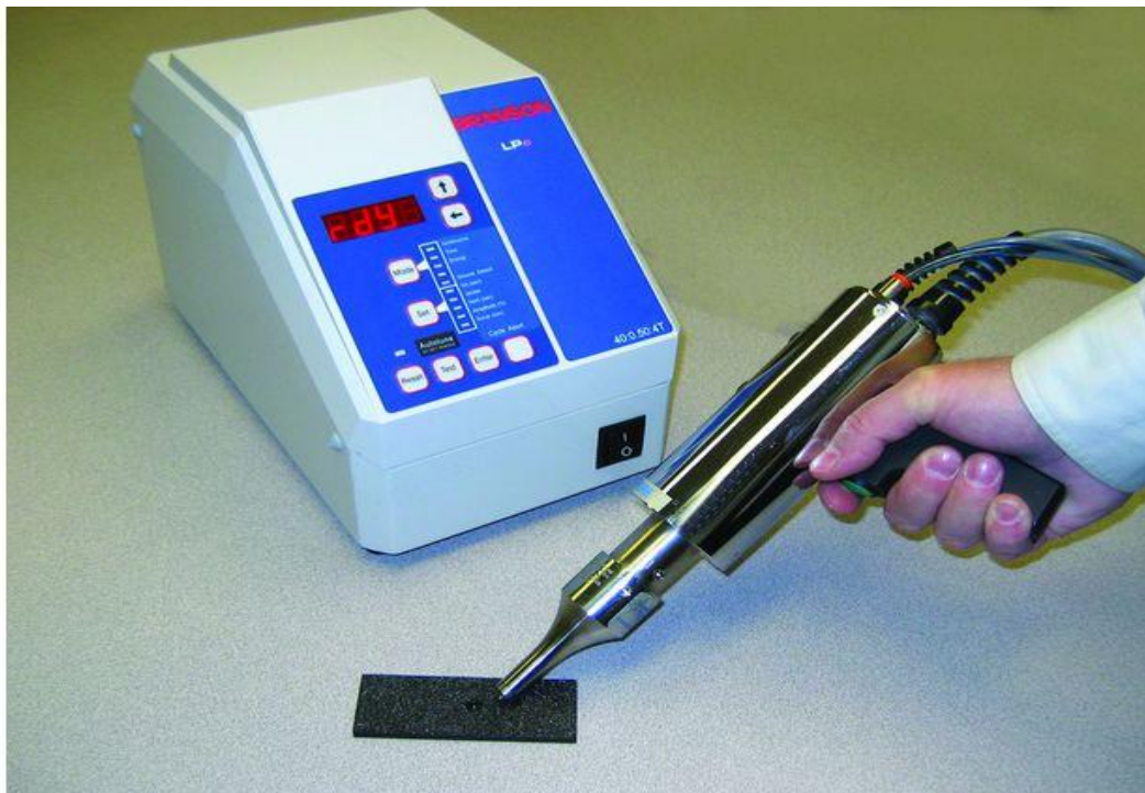
Fig I.13 Le soudage par ultrasons
