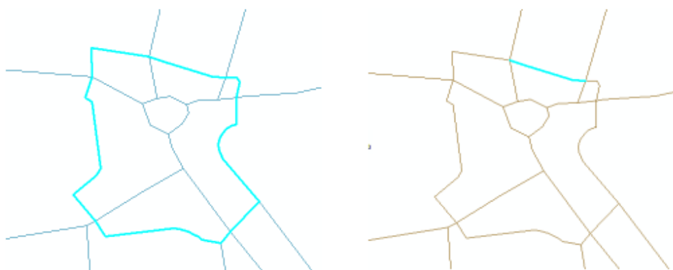
Figure 36 : La séparation des segments à chaque intersection. A gauche, une ligne représentant une voie, données brutes depuis OSM. A droite, ligne découpée en segments à chaque intersection. Source : Auteur
