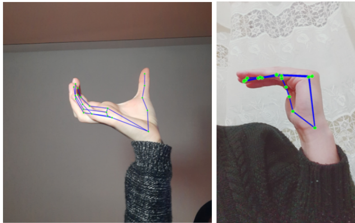
Fig. 3.4 : Visualisation des 21 landmarks de la main détectés par MediaPipe pour deux images de notre jeu de données, appartenant respectivement aux classes 'espace' et 'delete'
