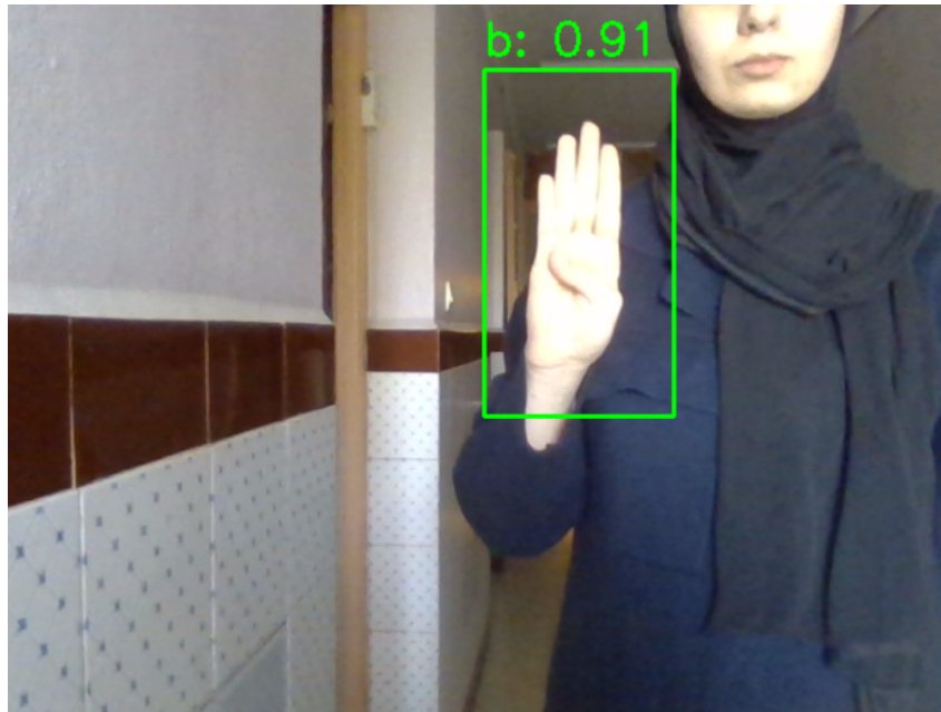
Fig. 3.8 : Prédiction en temps réel avec EfficientNetB0 : détection de la main, cadrage et affichage du niveau de confiance.
