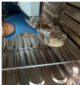
Figure 03 : détermination de l'humidité des farines infantiles (photos originales).
