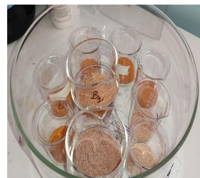
Figure 03 : détermination de l'humidité des farines infantiles (photos originales).
