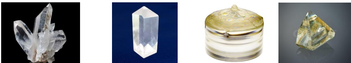
Figure I.6. Cristaux de Quartz, KDP, \text{LiNbO}_3 et KTP
