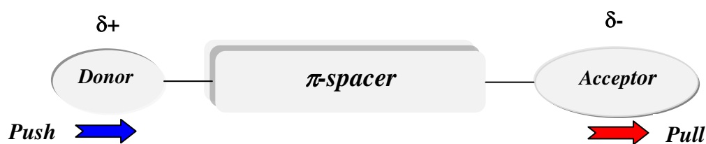
Schéma III.2.1 Illustration schématique d'un chromophore push-pull D- \pi -A.
