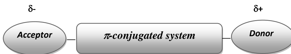
Schéma III.1.1. Illustration schématique d'un chromophore organique D- \pi -A de type push-pull .
