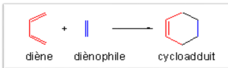
Schéma 1 : Réaction Diels-Alder
