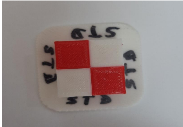
Figure I- 7: Modèle « Dual-Color-Cube » imprimé sur la RAISE3D Pro2
