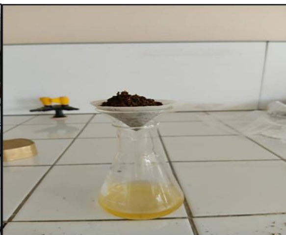
Photo 07 : Filtration de la solution (Tlemcen le 20/04/2026).
