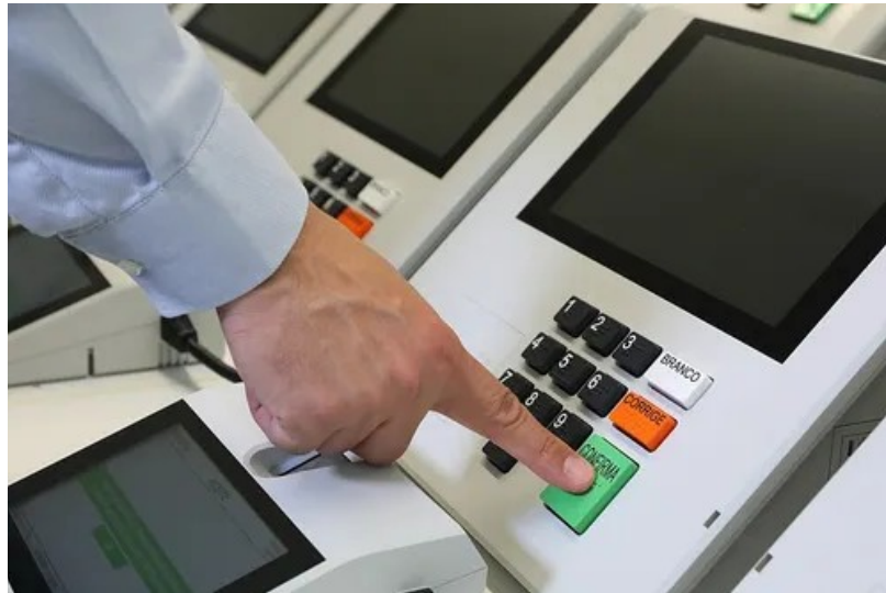
Figure I.2 : Exemple de machine de vote électronique DRE
