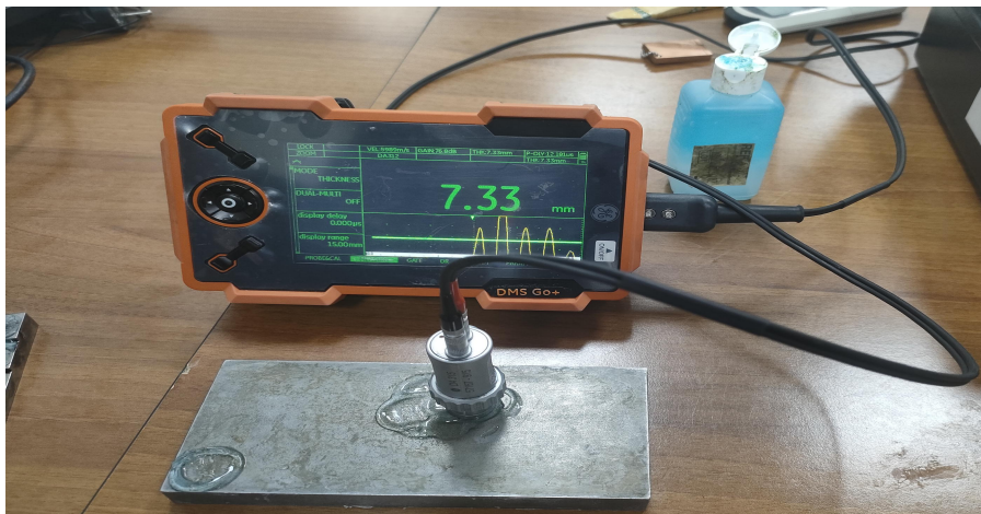
Figure 27 : Contrôle d'épaisseur par ultrasons (UT).
