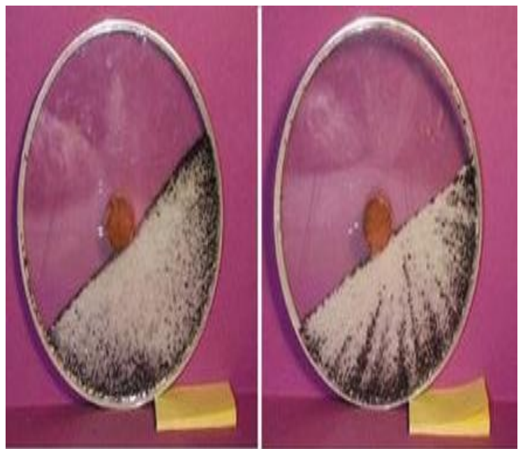
Figure I-9 : ségrégation en tambour tournant [f-9]
