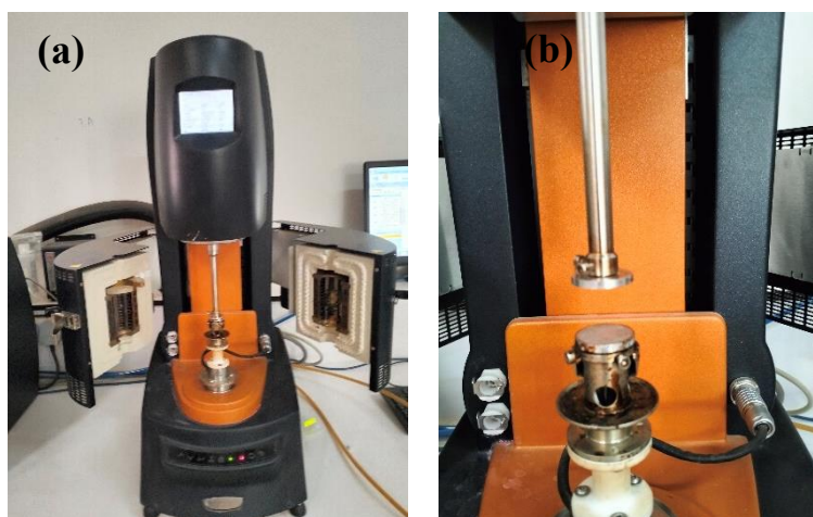
Figure II.6 : (a) Rhéomètre TA Instruments DHR-2 et (b) sa géométrie plan-plan (LRM, Université Abou Bekr Belkaid Tlemcen).
