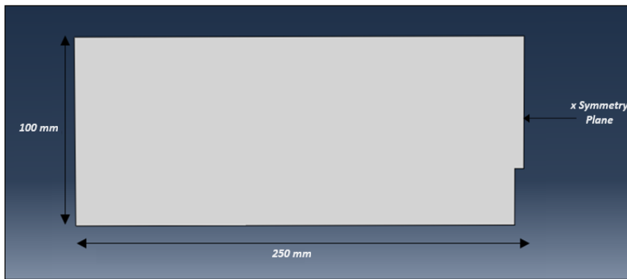
Figure IV. 20 : Géométrie de la poutre entaillée
