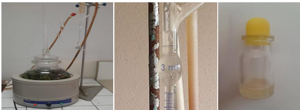
Figure 5: Les différentes étapes d'extraction d'huile dans l'appareil de type Clevenger (photo prise au laboratoire).
