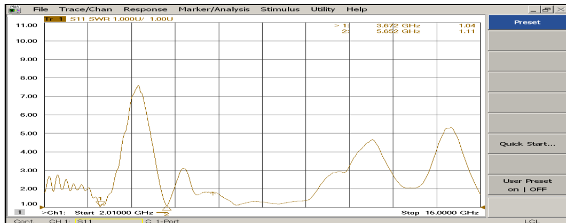
Figure III. 62 VSWR du réseau d'antenne
