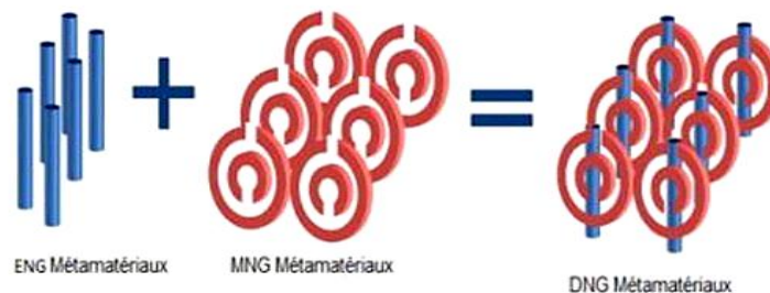
Figure II.8: Combinaison de fils minces et SRR pour former des métamatériaux DNG [40].
