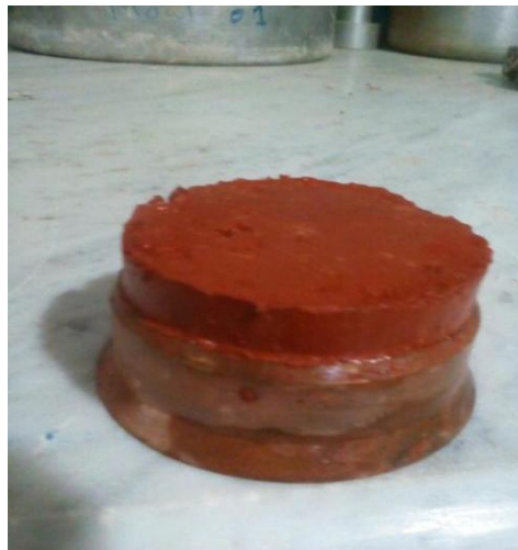
Figure III. 17: Résultat de l'essai du potentiel de gonflement d'argile AA
