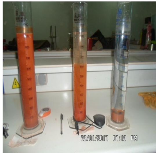
Figure III. 8: Essai de sédimentométrie, (laboratoire GC, université d'Adrar).
