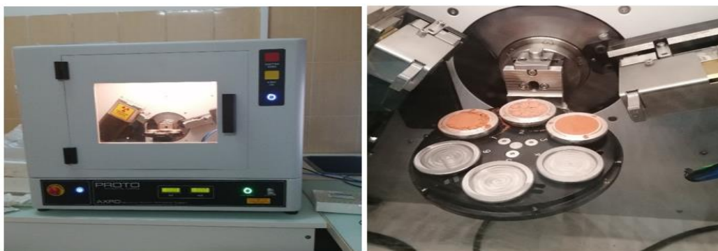
Figure III. 5: Schéma du mode opératoire et de l'appareillage de rayons X à réflexion des trois argiles, (laboratoire SM, université d'Adrar)
