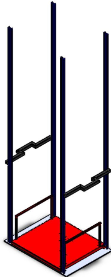
Figure III-2 : Monte charges après simplification
